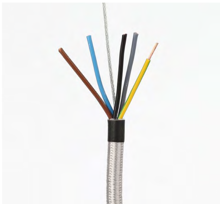
Textilkabel 5-adrig 5x0,75 mm 2 mit Stahlseil als Zugentlastung
