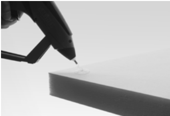
Montage mit Heiß- und Montagekleber
